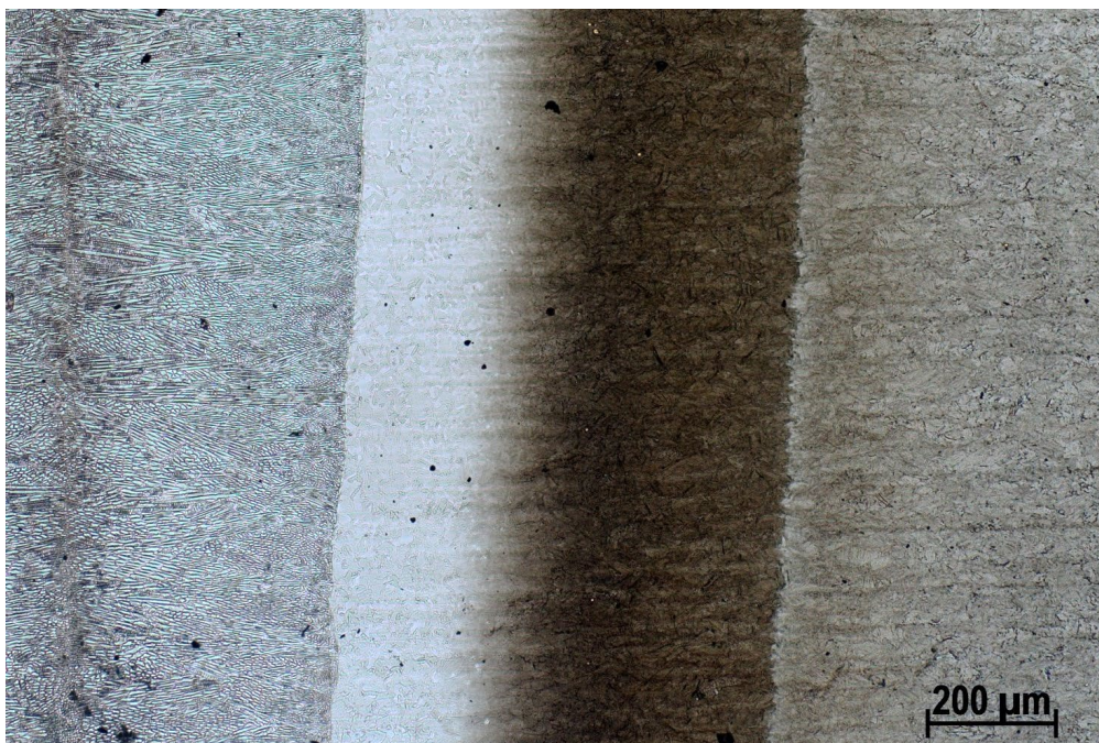
Рисунок 2 – Микроструктура зоны термического влияния в средней части шва, 100х
