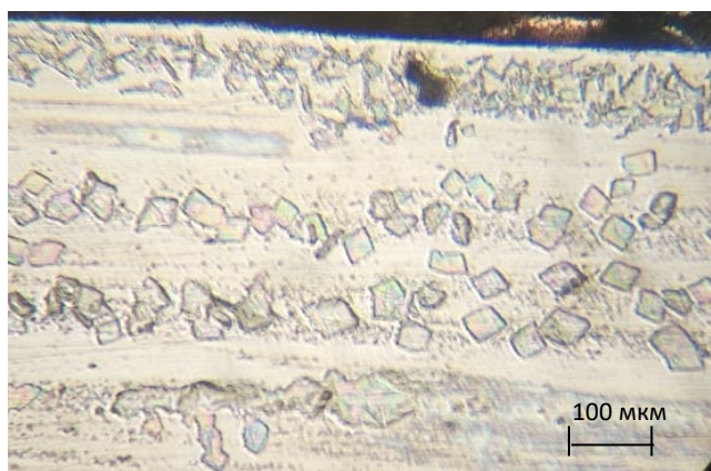
Рисунок 3 – Микроструктура сплава Fe – основа; 0,12% С; 0,8% Si; 0,84% Mn; 17,8% Cr; 10,85% Ni; 0,62% Ti; 0,013% S; 0,03% P после азотирования при температуре 570°С в течение 6 часов
