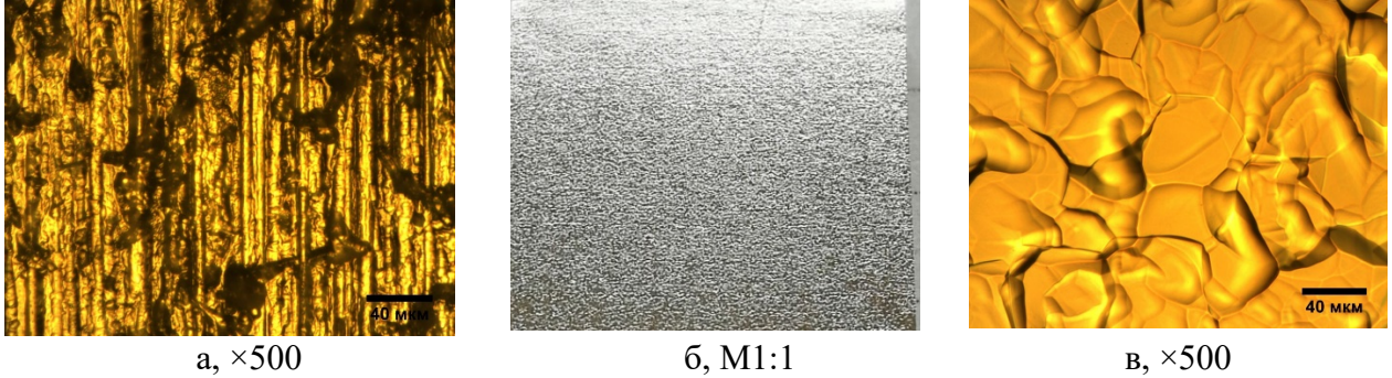
Рисунок 1 – Вид поверхности образцов из ниобия фирмы Ningxia: в исходном состоянии (а) после химического травления в смеси кислот (б, в)
