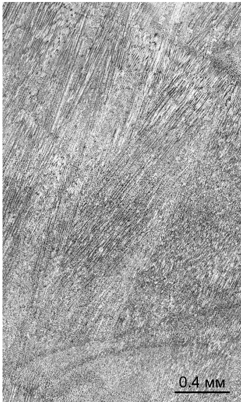
Рисунок 3 – Микроструктуры наплавленного металла без модуляции тока: а – панорамный снимок, \times 100 ; б, в – зона сплавления, \times 500
