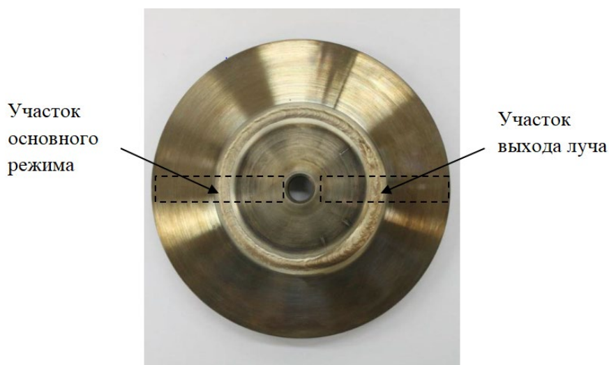
Рисунок 4 – Схема вырезки образцов для механических испытаний
