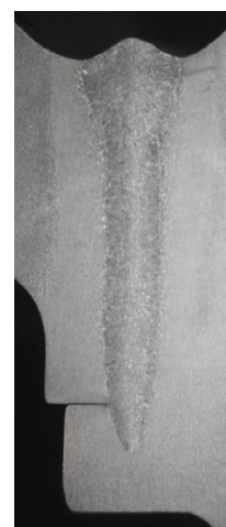
Рисунок 12 – Шлифы образца-свидетеля зубчатого колеса: а) участок перекрытия; б) участок основного режима сварки
