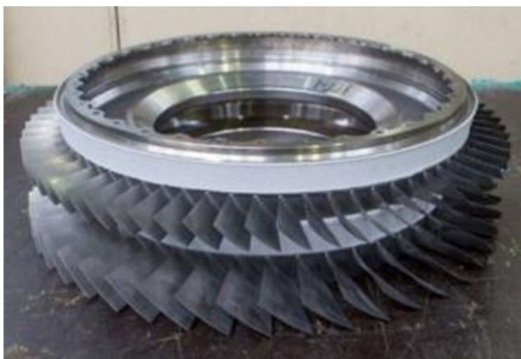
Рисунок 1 – Сварной узел рабочего колеса 1 и 2 ст. КВД из сплава ВТ 41 после окончательного фрезерования лопаток
