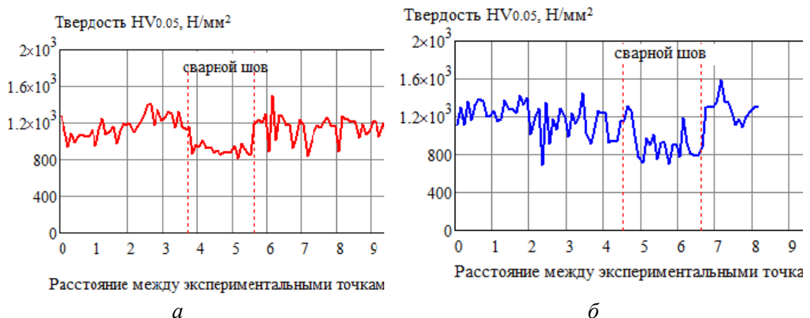
Рисунок 14 – Микротвердость сварных соединений сплава 1420 при ЭЛС, а – с ТВО, б - без ТВО
