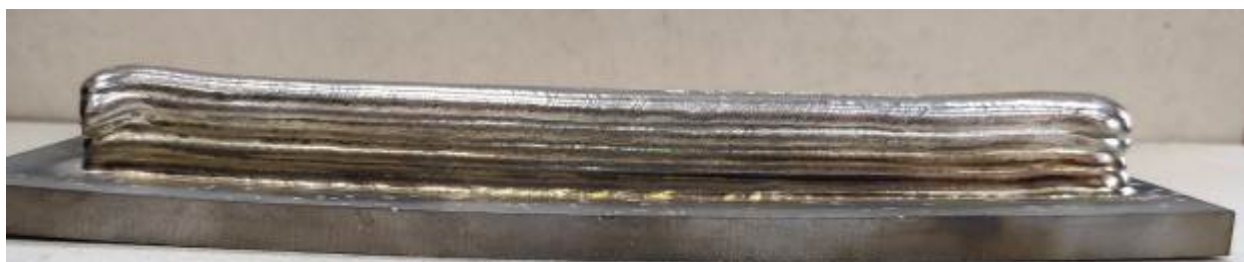
Рисунок 1 - Внешний вид стенки, полученной многослойной плазменной наплавкой в контролируемой атмосфере
